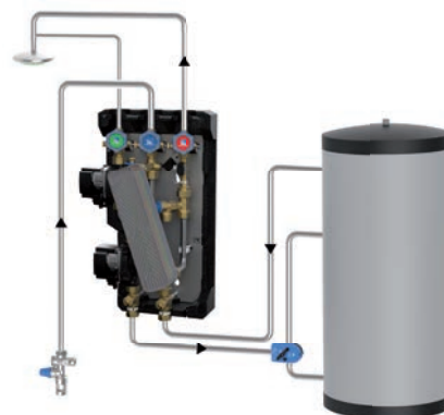
Montagebeispiel: FriwaMini mit Zirkulation, Rücklaufverteilsset und Trinkwasserspeicher-Sicherheitsgruppe
