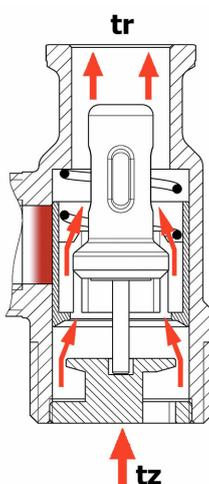
Mit steigender Temperatur im Kesselvorlauf bzw. steigender Temperatur aus dem Speicherrücklauf [tz] öffnet das thermische Ventil den Weg zum Speicher. Die Temperatur des Kesselrücklaufs ist im Betrieb annähernd konstant ( $\pm 3$  K).
