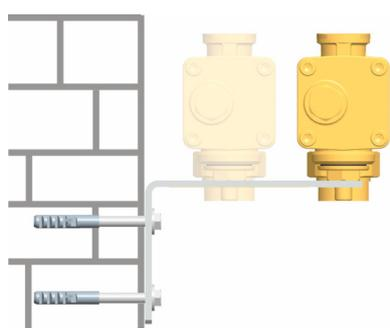
Se possibile, scegliere i fori di fissaggio più lontani rispetto al muro. In tal modo è possibile montare facilmente l'isolamento del collettore modulare.
