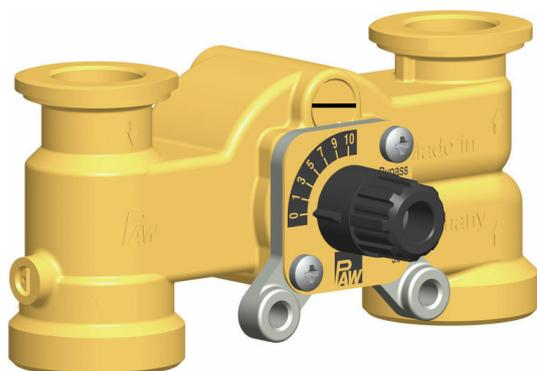
Se la tacca della vite bypass è in posizione orizzontale, il bypass è completamente aperto. Il massimo flusso in volume scorre dal ritorno nella mandata. Questa impostazione è necessaria per riscaldamenti a pannelli radianti laddove sia necessaria una grossa quantità di acqua in circolazione. Tramite il bypass la temperatura di mandata viene ridotta, influenzando sulle prestazioni del regolatore.
