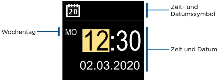
Mit den Tasten  $\ominus$  und  $\oplus$  können Sie den Wert ändern und mit der Taste  $\odot$  können Sie zu den nächsten Daten übergehen. Verlassen Sie den Bildschirm mit der Taste  $\odot$ .
