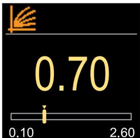
Sie können die Steilheit der Heizkurve einstellen. Die Steilheit kann mit den Tasten ⊖ und ⊕ eingestellt werden.
