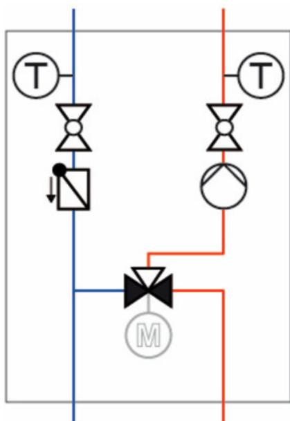
**K32 – HeatBloC® avec vanne mélangeuse à 3 voies**
