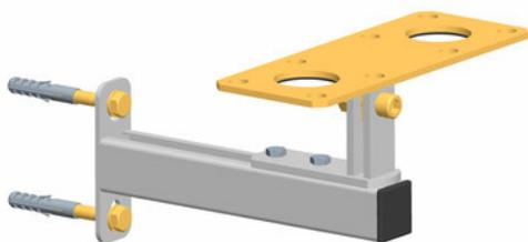
1. Fixez la console murale au mur en utilisant des vis et des chevilles appropriées.
