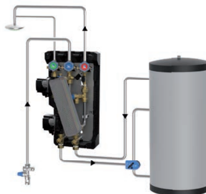
Exemple de montage : FriwaMini avec circulation, kit de distribution retour et groupe de sécurité du ballon d'eau chaude sanitaire
